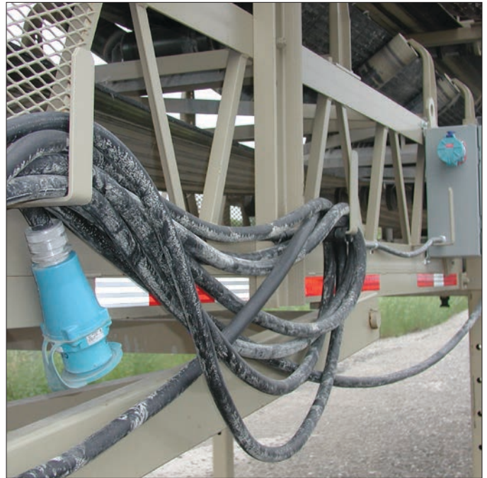
Una típica instalación de banda transportadora portátil incluye una clavija y un tomacorriente MELTRIC en el panel y un cable de alimentación. La fácil conexión con giro de MELTRIC no es afectada por la arena como en la tuerca roscada en los dispositivos de punta y manga anteriores.
