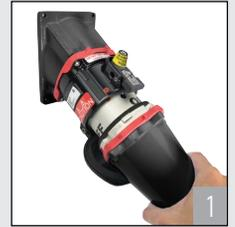
Antes de conectar, asegurarse que el circuito esté desenergizado. Alinee los puntos rojos, empuje la clavija parcialmente hacia adelante, después gire un poco en sentido de las manecillas del reloj para alinear el gatillo con el pestillo.
