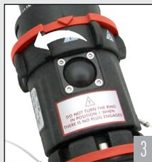
Para desconectar, abra el circuito auxiliar y libere la clavija girando el anillo hasta alinear el "0" con la flecha. Esto desenergiza el circuito.
