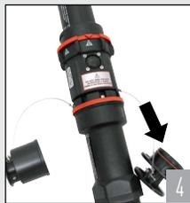
Presione firmemente en el botón y jale la clavija simultáneamente. Una pequeña rotación de la clavija puede ser necesaria.
