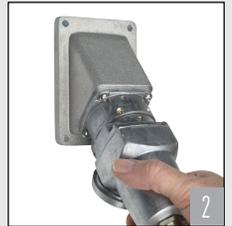
Para remover la clavija, gire la clavija en sentido contrario a las manecillas del reloj y aplique fuerza para deslizarla hacia atrás.
