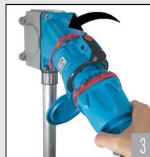
Al rotar la clavija desenergizada 30° en contra del sentido de las manecillas del reloj, se cierra la cortinilla de seguridad y se libera la clavija, para ser retirada del tomacorriente.
