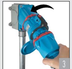
3 Al rotar la clavija desenergizada 30° en contra del sentido de las manecillas del reloj, se cierra la cortinilla de seguridad y se libera la clavija, para ser retirada del tomacorriente.
