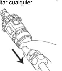
Para cerrar el circuito piloto y bloquear mecánicamente la clavija al tomacorriente, gire el anillo del tomacorriente hasta que el "1" esté alineado con la flecha que cruza desde el botón de liberación del seguro. Figura 4.
